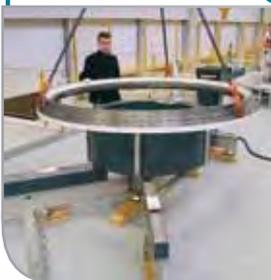
Ce dispositif spécial développé pour une application éolienne, est capable de chauffer à 120°C en 60 minutes, des pièces pesant jusqu'à 10 tonnes avec un diamètre extérieur de 4 mètres.
