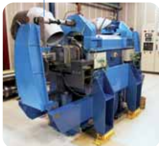
Испытательная установка для проверки подшипников SNR.
